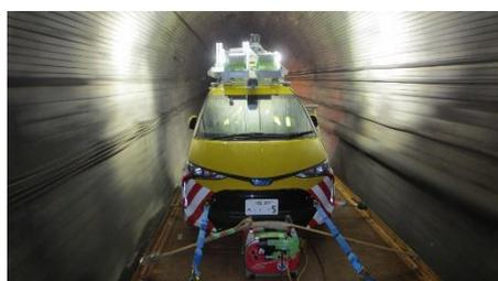
3次元点群データ計測車両
