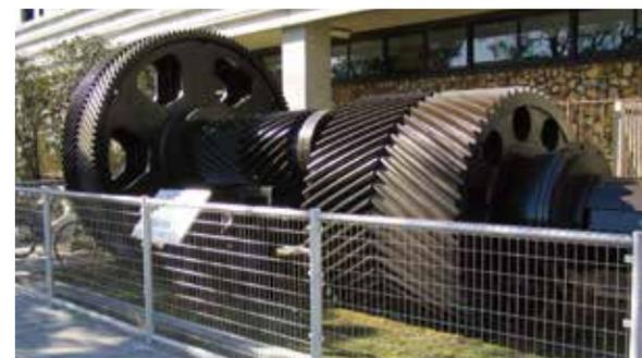
30年間にわたり日本冶金工業の主力設備として使われたプラネタリー熱間圧延機フィードロール減速機用の歯車。
