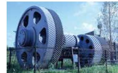
這是行星式熱軋機推進渦輪減速機用的齒輪，作為日本冶金工業的主要設備，使用了30年之久。
