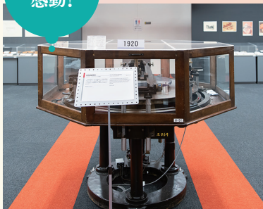
中心に設置した直径1メートルまでの円盤の円周上に目盛りを刻んで正確な分度器等を作る大型の目盛加工機械（1920年製）。実際に動く様子が見られる
