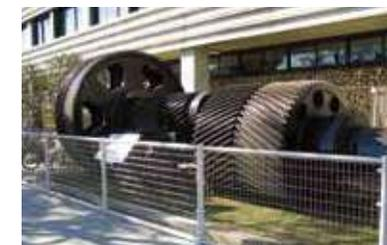
行星轧机进料辊减速机用齿轮,作业日本冶金工业的主力机器活跃了30年。
