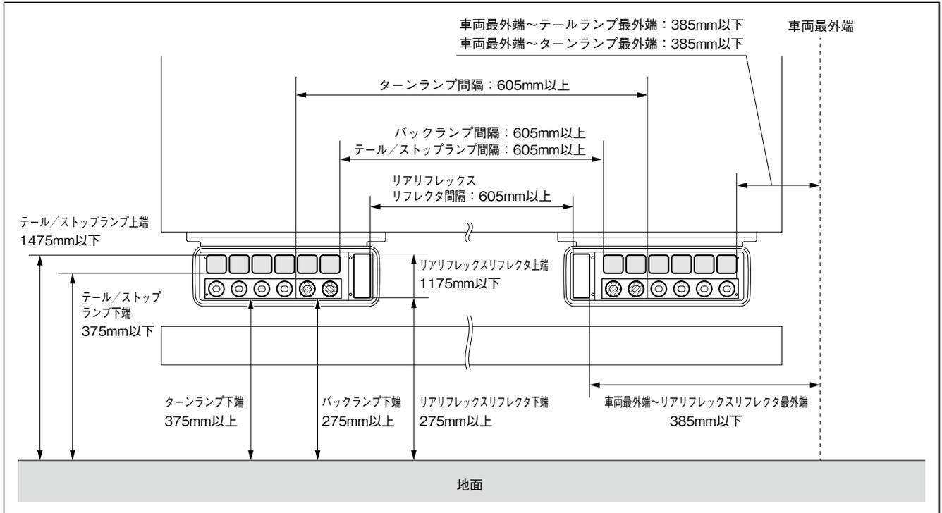
※本製品のリアフレックスリフレクタの取り付け位置が 車両最外端より 400mm (小糸推奨取り付け寸法：385mm) 以上となる場合は、追加 (別売) のリアフレックスリフレクタを 車両最外端より 400mm 以内 / 上端 900mm 以内 (地上高) に取り付けして下さい。
