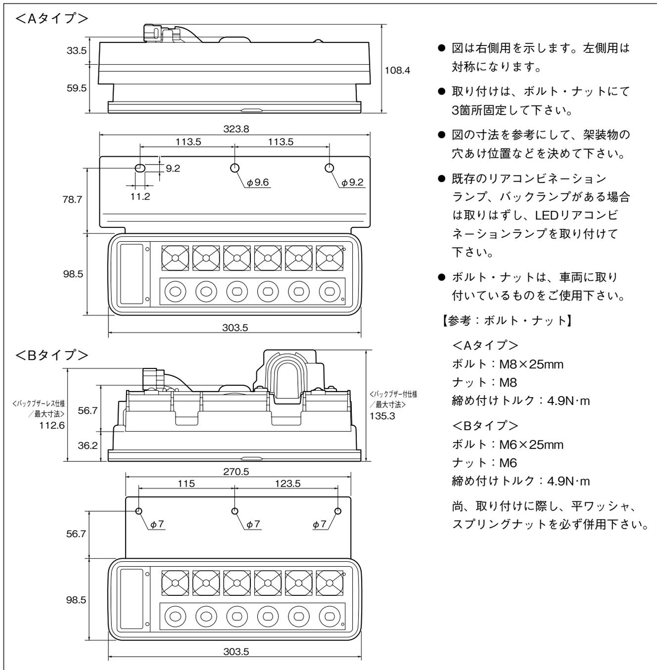
● 取り付け例 (図はAタイプの右側用を示します)
