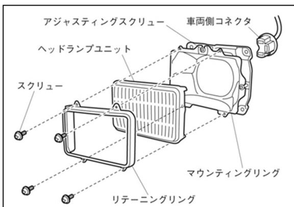
現在装着されているヘッドランプユニットを取外します。
