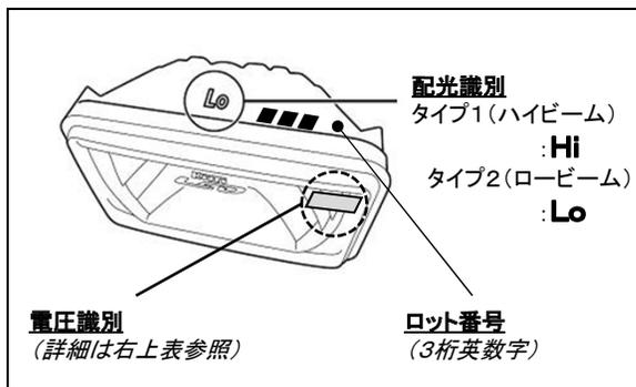
交換用に用意したLED-HLの電圧が車両で使用しているバッテリー電圧と同じであることを確認してください。
