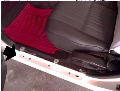
図6 Bピラーカバー取外し状態
